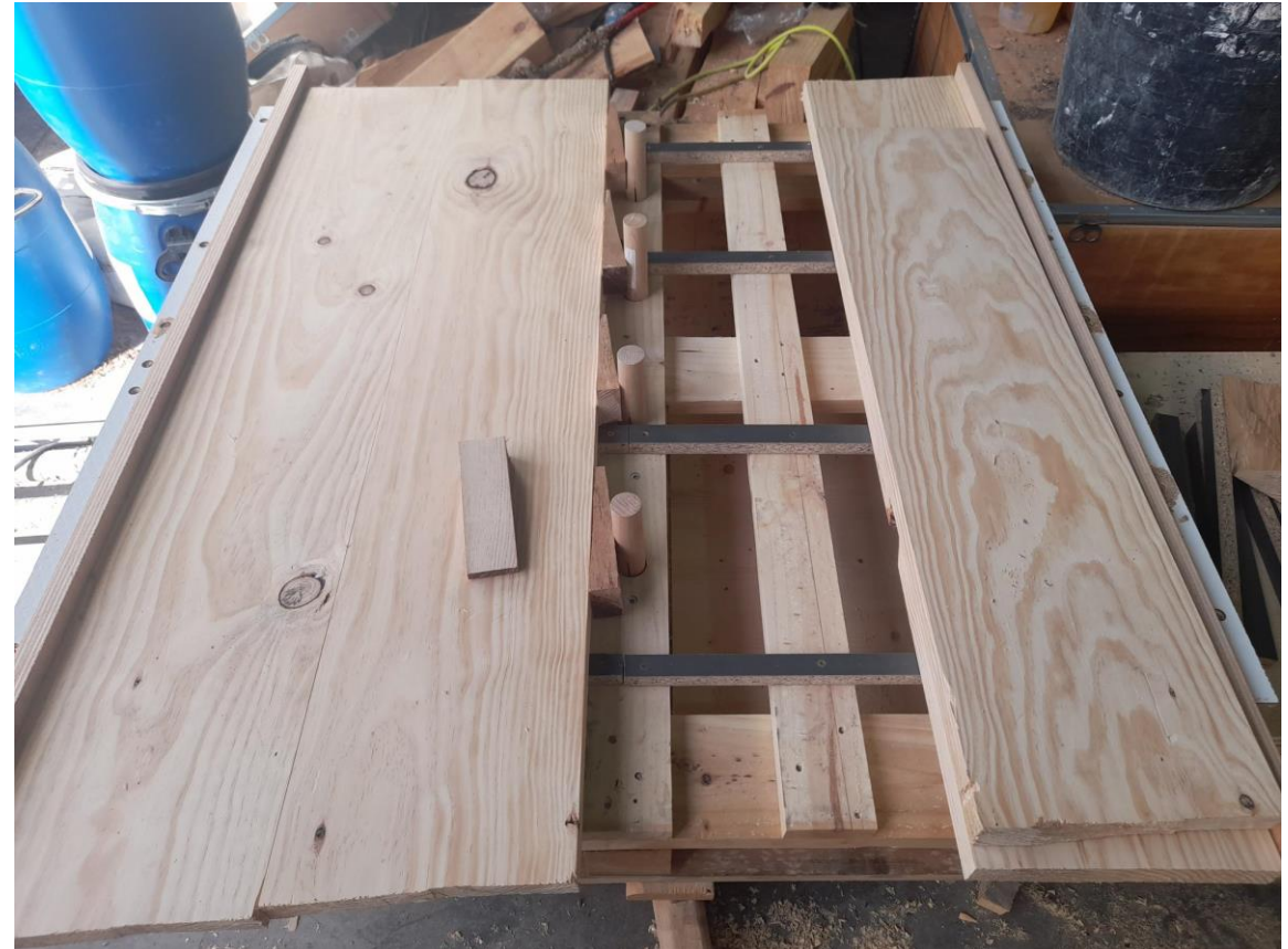
Bastidor para fabricar muestras de 50 x 50 (ensayo cortante)
